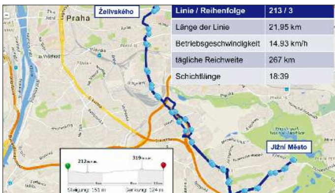
2. Strecke und Parameter der Buslinie 213, auf der der Elektrobus montags bis freitags eingesetzt wird. Die Linie entspricht ungefähr dem SORT-1-Profil. Die Linienlänge bezieht sich auf einen Umlauf (Hin- und Rückfahrt). Abb (2): DPP
