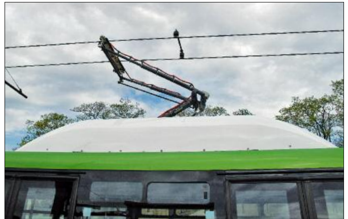
13. Zweipoliger Pantograph am Draht
