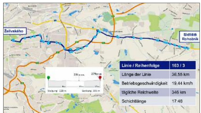
4. Strecke und Parameter der Buslinie 163, auf der der Test-Elektrobus an Wochenenden eingesetzt wird. Die Linie entspricht ungefähr dem SORT-2-Profil. Auch hier ist die Linienlänge für eine Hin- und Rückfahrt angegeben.
