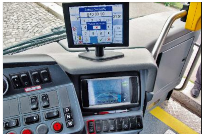
14. Bedienungspaneel des Pantographen mit Videoüberwachung
